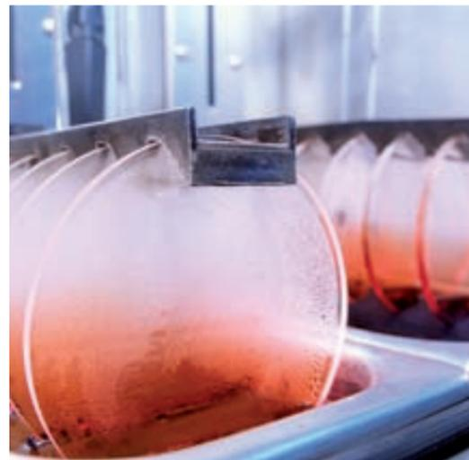
Amplitudengesteuerte Tauchbäder – so entstehen Verlaufsfilter
